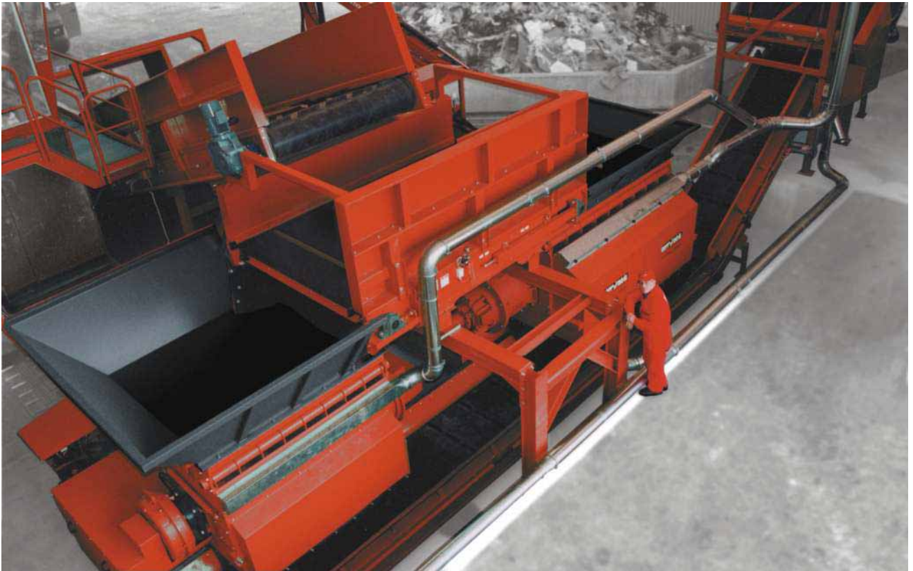
Kombination WLK 30 S-J. mit hydraulischem Antrieb und WLK 20 S-J. mit mechanischem Antrieb, XO-Group (Finnland) Combination WLK 30 Super-Jumbo with hydraulic drive and WLK 20 Super-Jumbo with mechanical drive, XO-Group (Finland)
