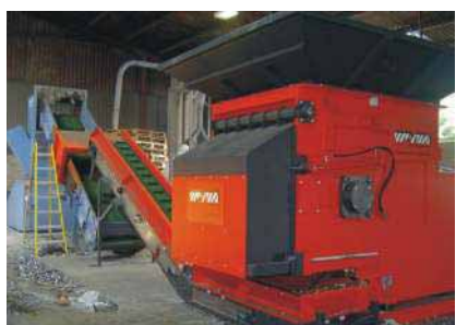
WLK Jumbo für die Zerkleinerung von Anfahrkuchen WLK Jumbo for shredding of lumps
